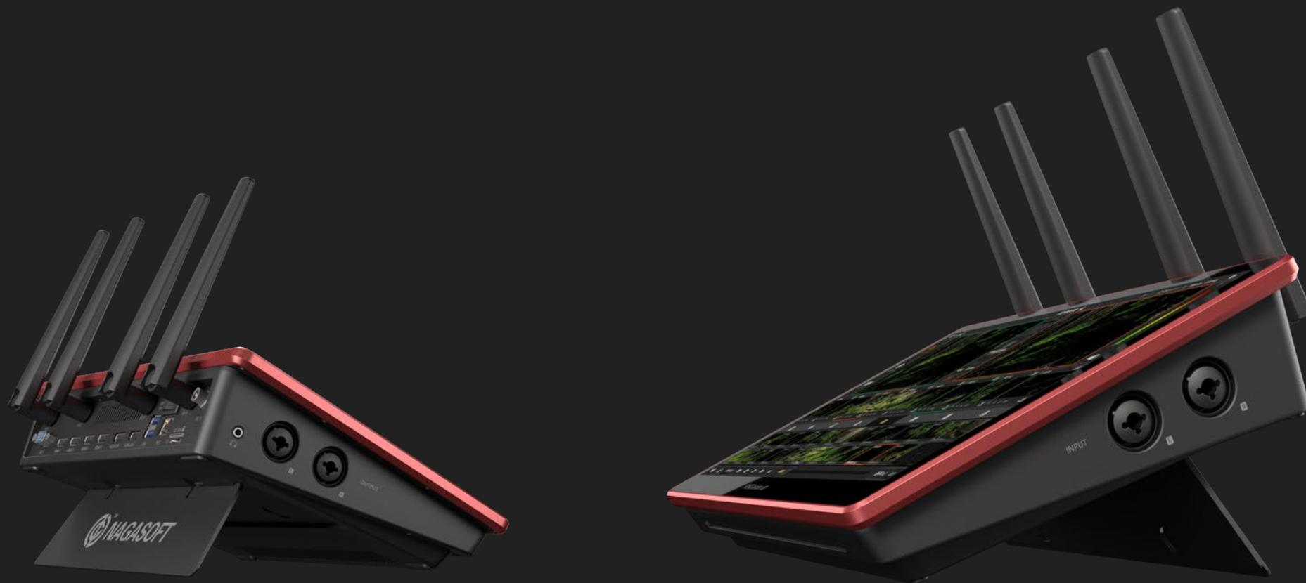
Для ввода и вывода звука предназначены комбинированные порты XLR/TRS, что обеспечивает возможность работать как с балансным, так и с небалансным звуком. Вы можете подключить к NSCaster X2 любое профессиональное аудиооборудование.
